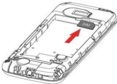
將 SIM 卡金屬點朝下、缺口處朝上(請參閱上圖)，SIM1 卡 15 度角推至底部，即可完成安裝。
