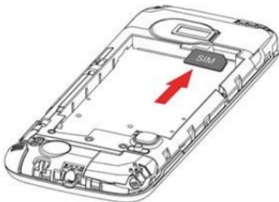
將 SIM 卡金屬點朝下、缺口處朝上(請參閱上圖)，SIM1 卡 15 度角推至底部，即可完成安裝。
